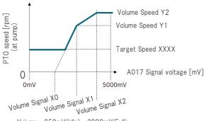
$\underline{\text{Volume}}$ ; 850mV(Idle) $\sim$ 3000mV(Full)
